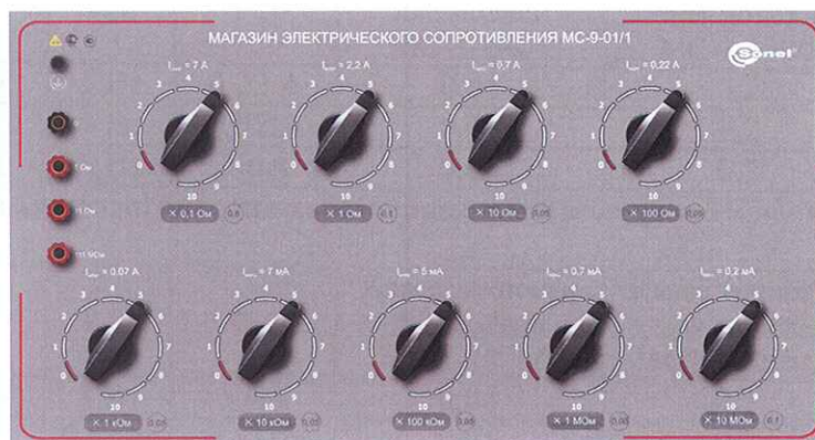
Рисунок 1 – Фотография общего вида магазинов электрического сопротивления.
