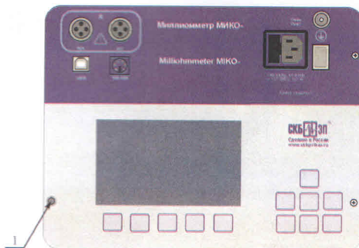
Рисунок 2 – Схема пломбировки от несанкционированного доступа 1 – место нанесения оттиска пломбы изготовителя
