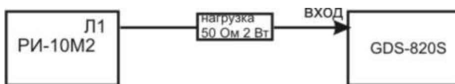
Рисунок 9-6 Схема проверки параметров зондирующего импульса
