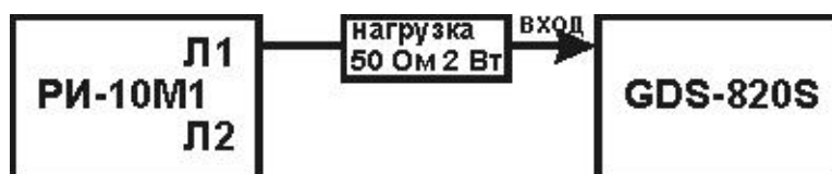
Рисунок 9-2 Схема проверки параметров зондирующего импульса
