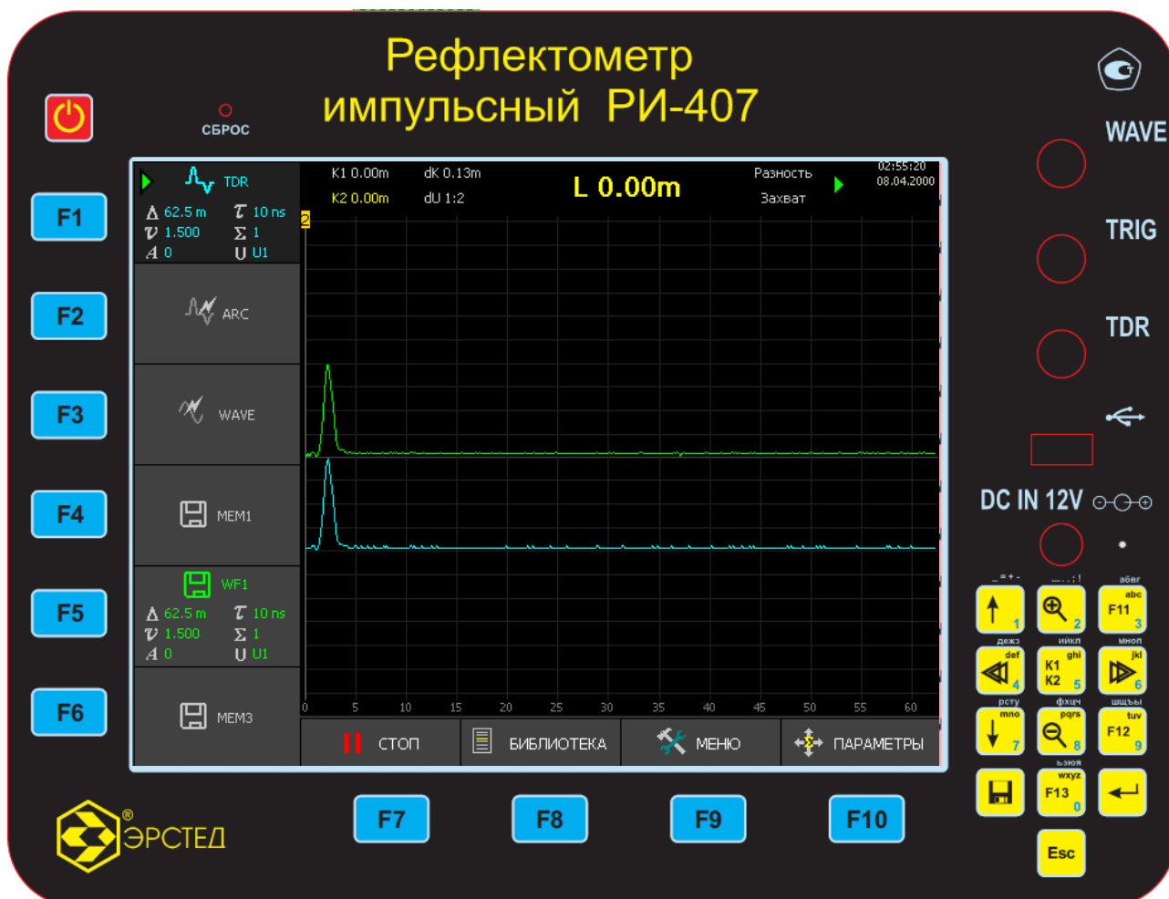
Рисунок 4.4. Лицевая панель прибора РИ-407
