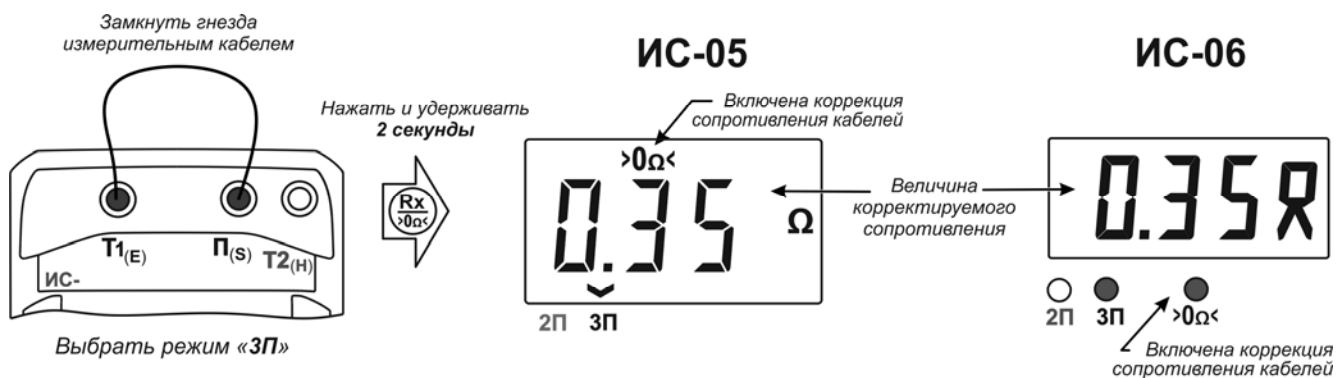
Рисунок 3 – Коррекция сопротивления измерительного кабеля (3П)
