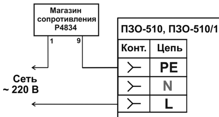
Рисунок 6.7.5 - Схема проверки погрешности измерений напряжения прикосновения
