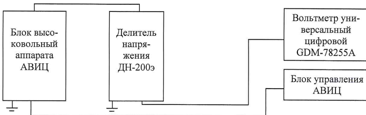
Рисунок 1 - Схема определения относительной основной погрешности измерений напряжения переменного тока промышленной частоты
