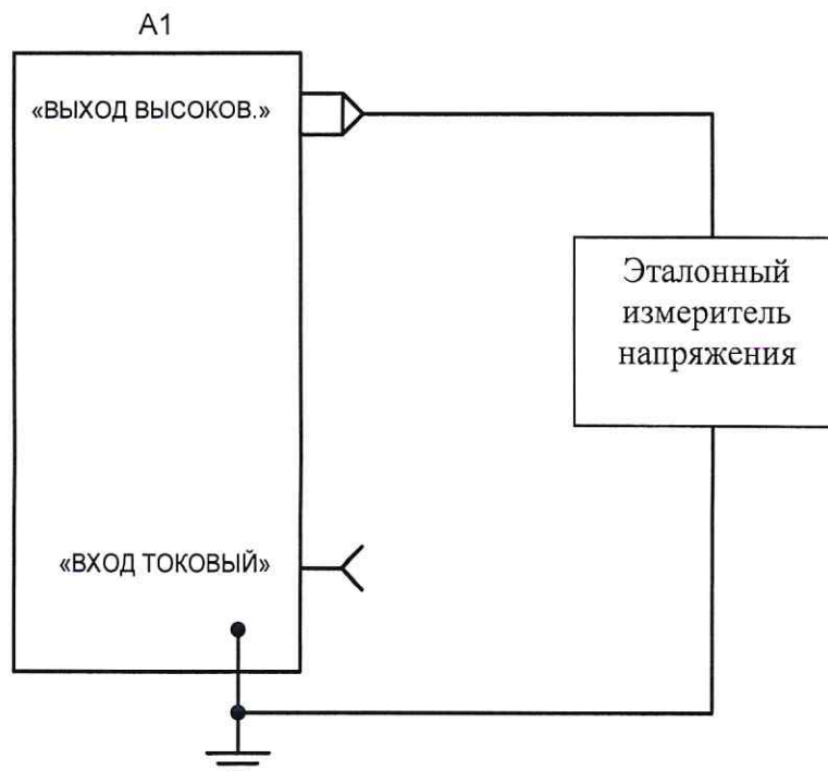
Рисунок 1 - Схема определения относительной основной погрешности измерений напряжения переменного тока промышленной частоты
